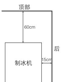
高湿度环境下，机器内部可能会产生冷凝水，从而滴在地上。因此，请勿将其安装在因滴水易受损坏的地板。
